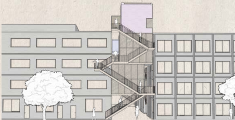
איור 70 - מבט על אזור התערבות 3, הדגמה של מערכת תנועה חיצונית מהרחוב למפלסי הבינוי החדשים
