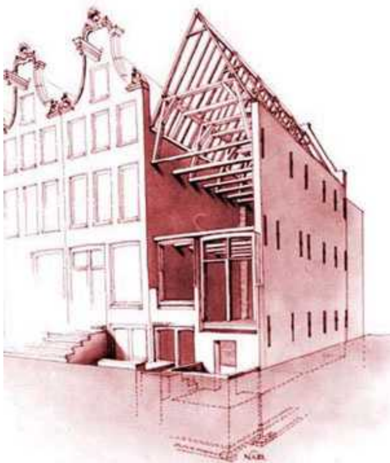
Construction of an Amsterdam canal house Het Bureau Monumenten & Archeologie
